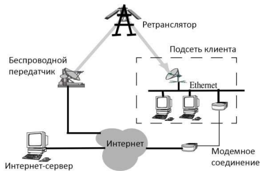
Рис. 12 - Пример «асимметричных соединений» при использовании спутниковых каналов связи.
