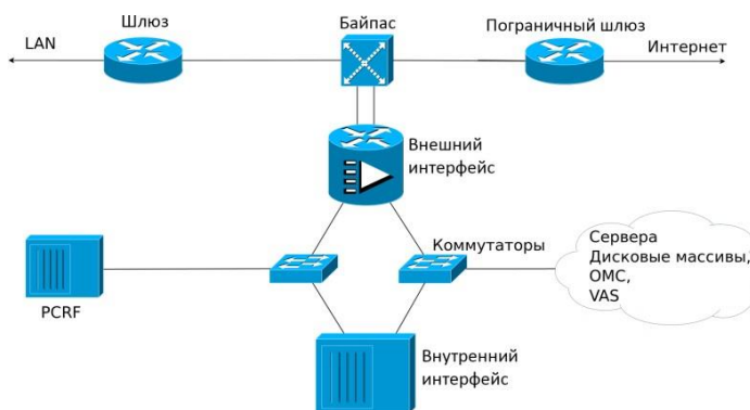
Рис. 6 - Схема использования системы DPI для применения политик к сетевому трафику.
