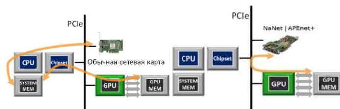
Рис. 15 - Схема потока сетевого трафика без применения (слева) и с применением (справа) технологий GPUDirect и DirectGMA.
